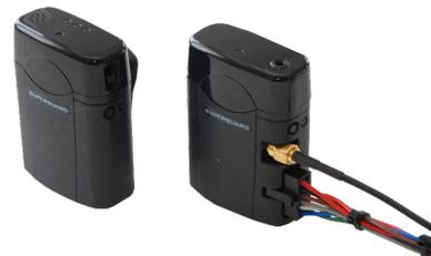
Set, bestehend aus tragbarem Pager (links) und Sender mit Antenne zur Festinstallation (rechts).
